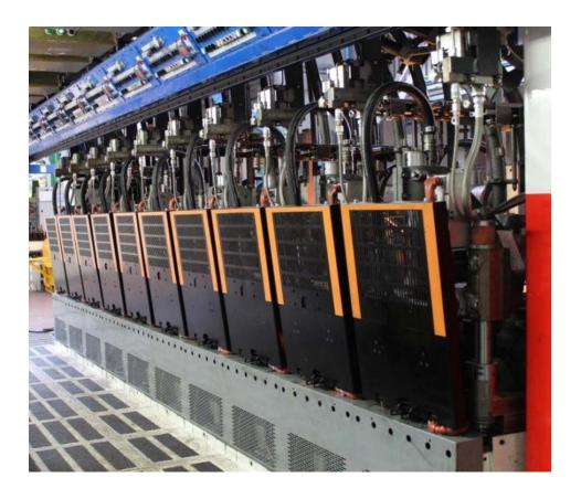
Absperrung auf der Vorformseite (Blank side Barrier) für AIS- und NIS-Maschinen
