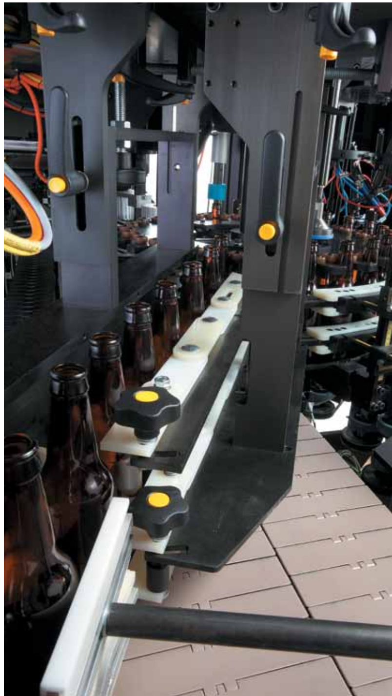
Подающий винт, недавно созданной установки типа M. Угол в 30° обеспечивает стабильность контроля тары.
