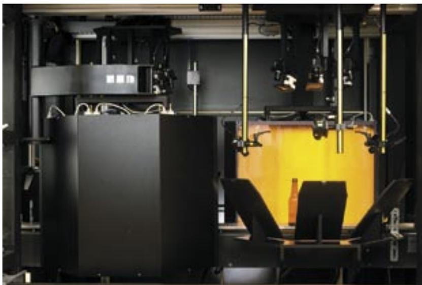
С появлением новейшего решения для инспекции стеклотары FleXinspect BC - системы, способной осуществлять контроль качества венчика, дна и стенки стеклотары, компания Emhart Glass смогла изменить концепцию эксплуатации современными операторами оборудования для визуальной инспекции. Кроме обновленного внешнего вида и графического интерфейса пользователя, Emhart Glass также добавляет новые функции, такие как, например, «простой режим» и программы-мастера настройки инспекции.
