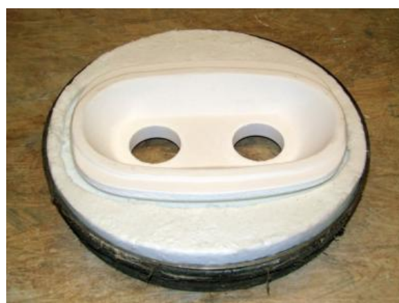
Una unidad completa de placa de orificio con bandeja, aislamiento preformado y placa de orificio.
