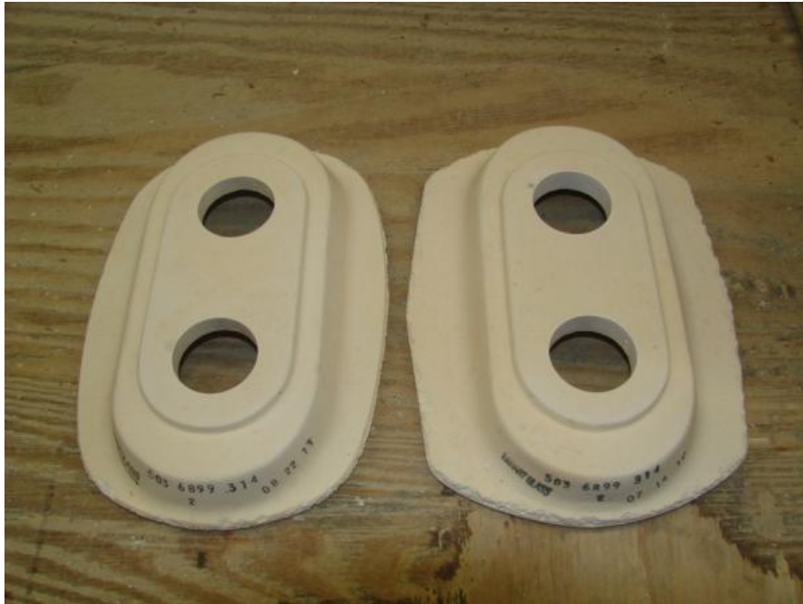
Placas de orificio de medición 515 del estilo nuevo (izquierda) y el estilo antiguo (derecha).
